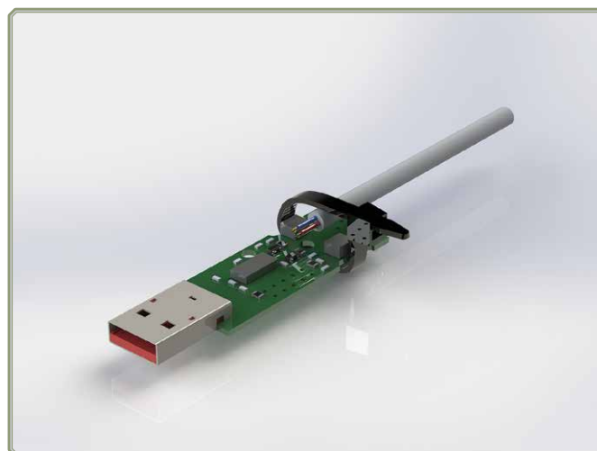
Slika 8: Končni izdelek z direktnim spajkanjem kabla in USB konektorjem tipa A
